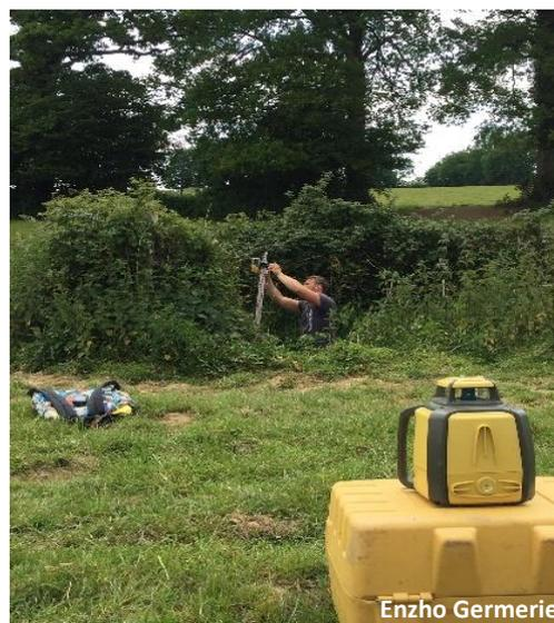
*Prise de côte sur une buse avec le laser et la mire*
