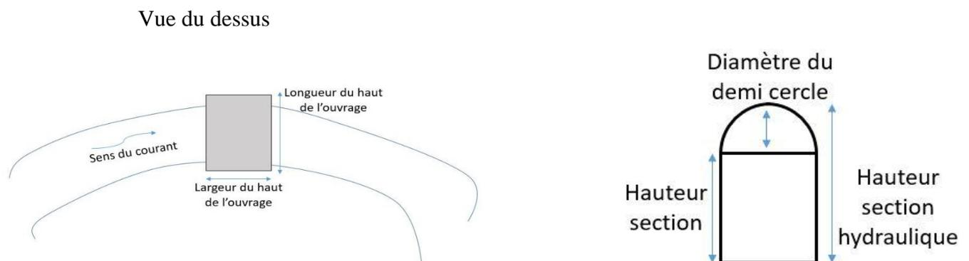
**Figure 16 : Schéma d'un pont voute**
